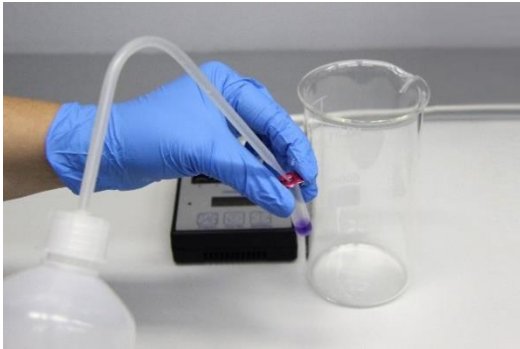
Figure 5 : Rinçage à l'eau déminéralisée
