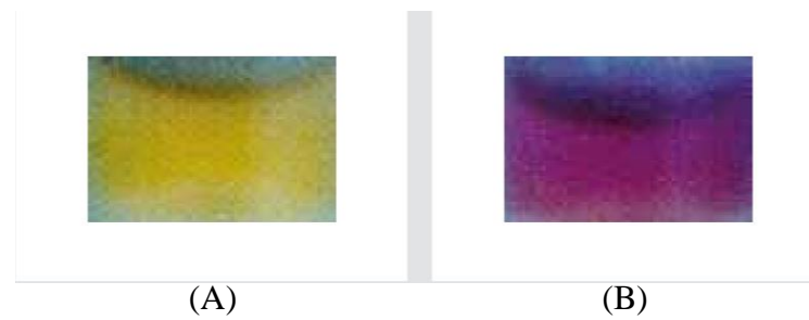
Figure 09 : Lecture des résultats sur Premi®Test ; (A) : Test négatif, (B) : Test positif.
