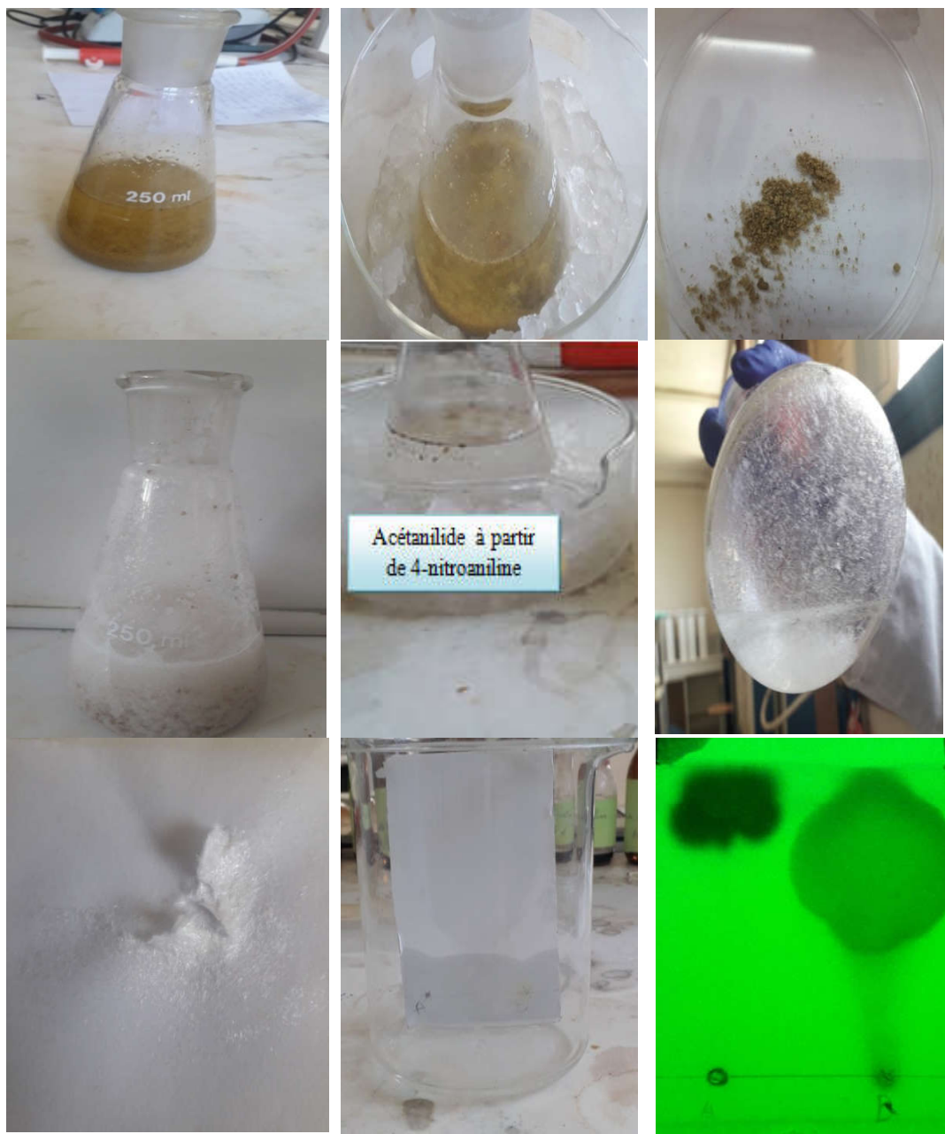
Figure II.10-Image photographique présente les différentes étapes de synthèse (Acétanilide)
