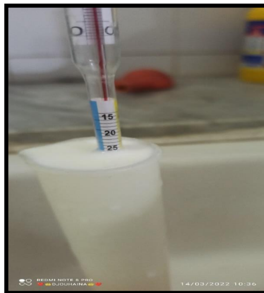
Figure 22 : Mesure de la densité par lactodensimètre
