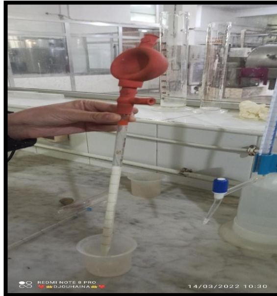
Figure 21 : Mesure d'acidité titrable en °D pour le lait reconstitué
