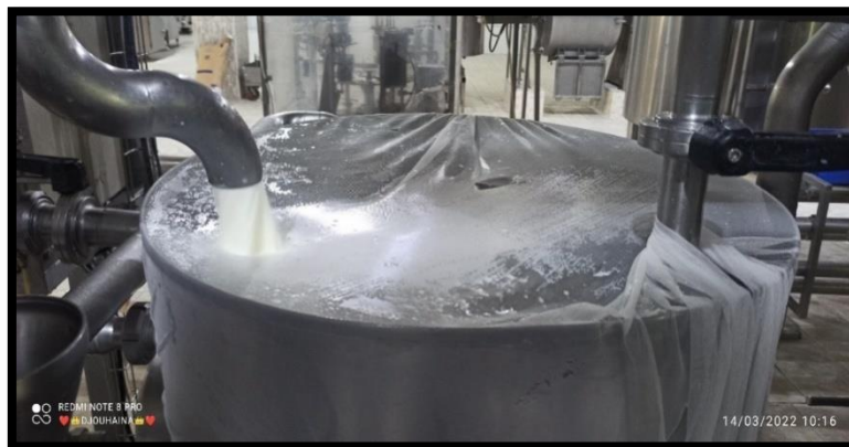
Figure 17 : processus de filtration du lait
