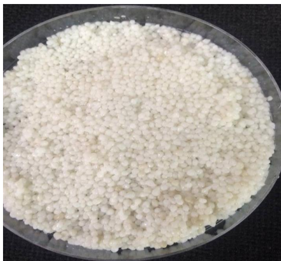
FigureIII. 4: biocomposite de diclofenac Argile/Alginate/chitosane
