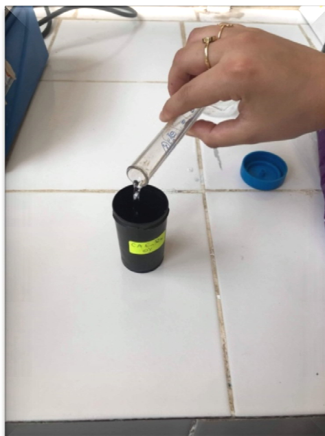
Figure 42 : Mélangé l'échantillon avec l'acétone et l'éthanol.
