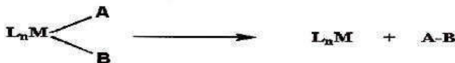
Fig. (1.9) : Réaction d'élimination réductrice,
