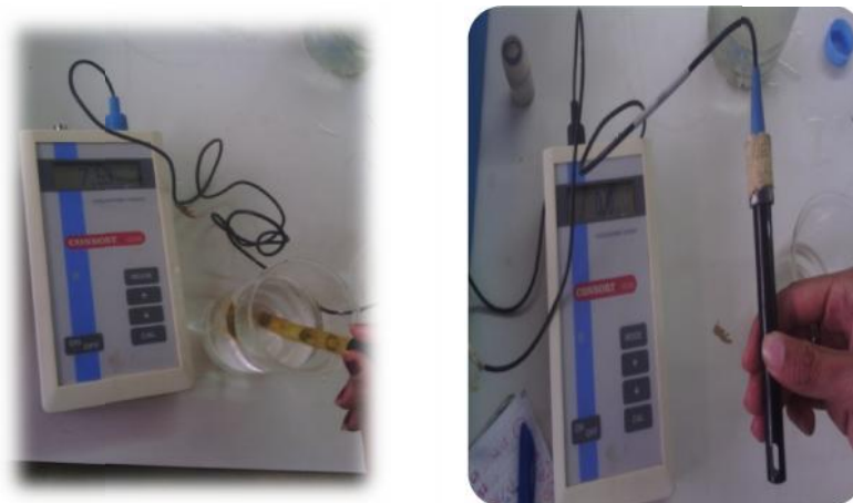
Figure N°30 : sondes de mesure de pH et de Conductivité électrique.
