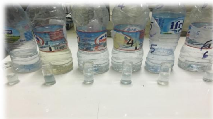
Figure N°34 : coloration bleue indicatrice de la présence de phosphore
