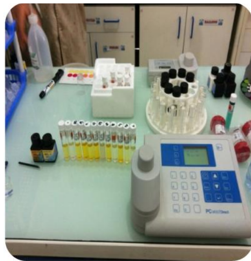
Figure N°29 : appareil multi paramètre à gauche et un spectrophotomètre uv-visible à droite
