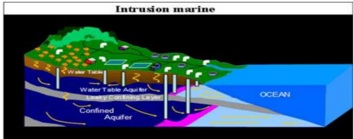
Fig.01 : Intrusion marine suite à un pompage intensif
