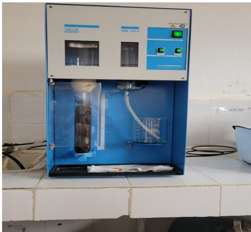
Figure 24. processus de distillation dans un appareil de distillation
