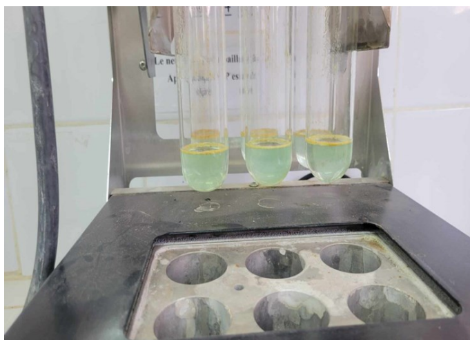
Figure 21. Margine chauffée à 100°C
