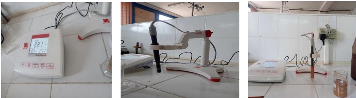
Figure 7. Conductimètre et mesure de la conductivité électrique
