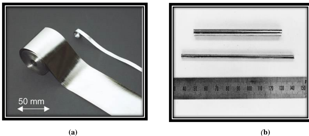
Figure I.13 : (a) Exemple de rubans de verre métallique à base de zirconium, (b) Exemple de tiges de verres métalliques à base de fer.
