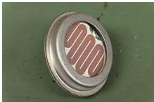
Figure I.5: Grande cellule photoélectrique CdS d'un lampadaire.
