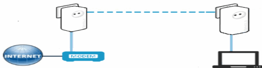
Figure II.3 : Exemple de câblage CPL.
