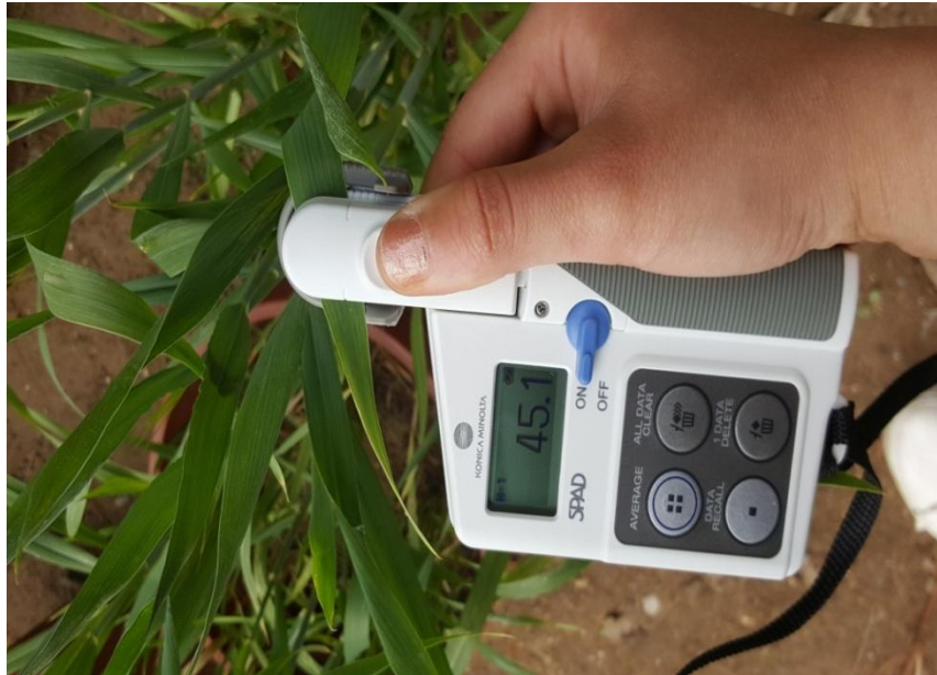
Figure 12 : Méthode de mesure par le SPAD502
