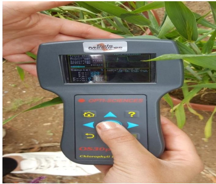
Figure 13 : Mesure des paramètres de fluorescence par le fluorimètre OS-30P
