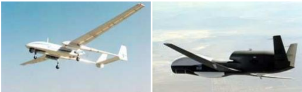
Figure 1.3: La forme des drones MALE et HALE
