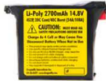
Figure 1.11: Batterie lithium-polymère à 4 cellules de 2700mAh. (la source : www.draganfly.com )
