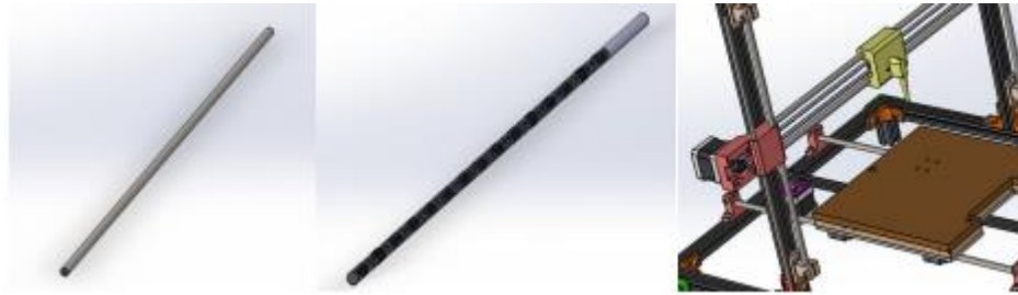
Figure 28 : Glissières et arbre fileté
