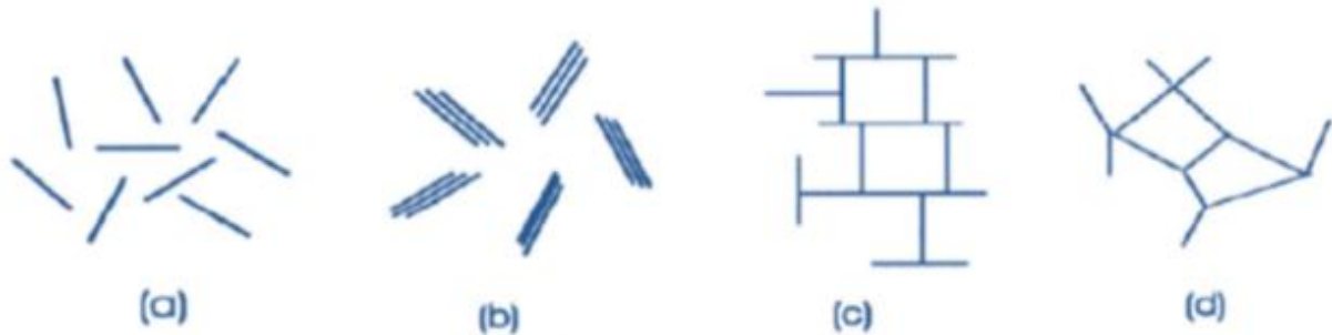
Figure I.6 : Modes d'associations supposés des feuillets de montmorillonite en suspension selon la théorie de Van Olphen(1964) : (a) dispersion, (b) agrégation face- face, (c) association bord-face, (d) association bord-bord [11].
