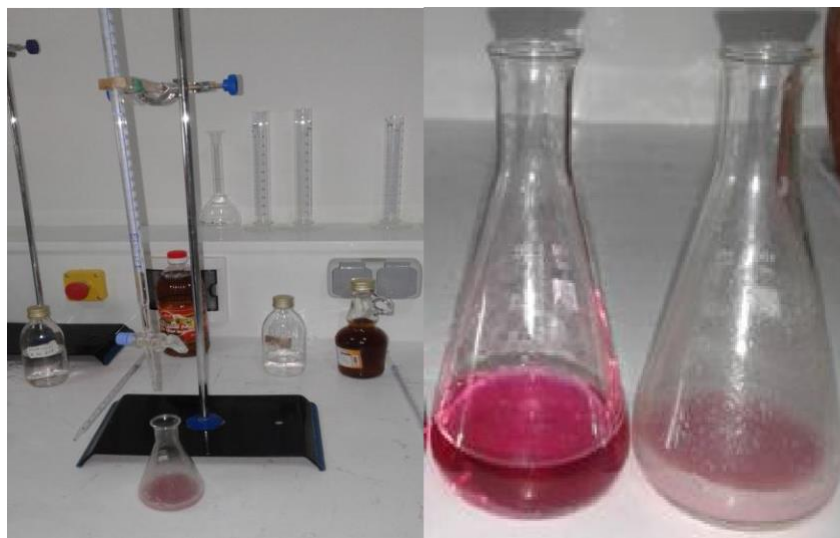
Figure) III.9(: Processus d'étalonnage en acidité totale .
