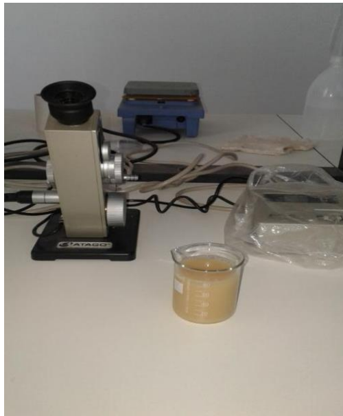
Figure) III.13): Processus de mesure d'indice de réfraction
