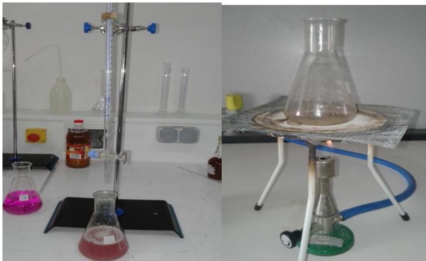
Figure ) III.10( : Processus d'étalonnage en acidité fixe.
