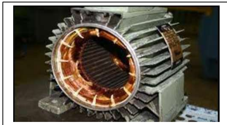
Figure I.2 : Vue réelle d'un stator d'une MSAP
