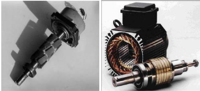
Figure II-1 Constitution de la machine synchrone à aimants permanents [4] [23]
