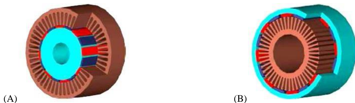
Figure II-2 Exemple de structures à rotor Interne [A] et à rotor Externe [B]. [22]
