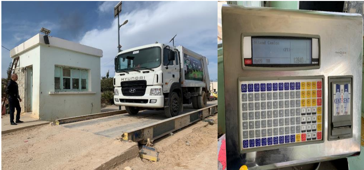
Figure 8: Pesage des déchets sur le pont bascule relié à un système informatisé.
