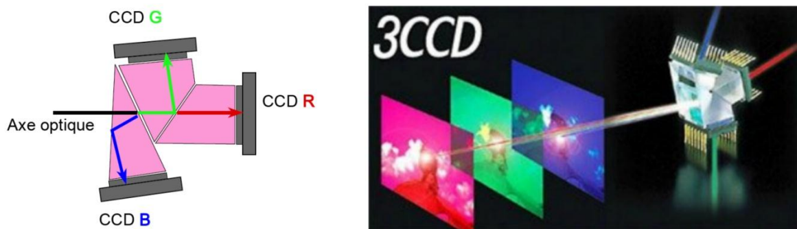
Figure I.23 : Schéma de principe d'un Capture Tri-CCD (charged coupled device) [S3]
