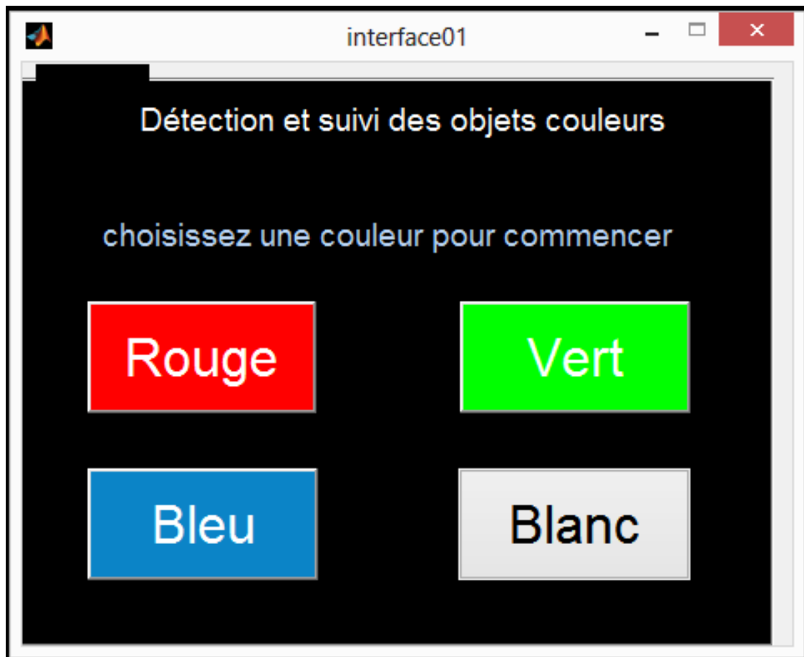
Figure III.4 : L'interface graphique de détection et suivi d'objet colorés
