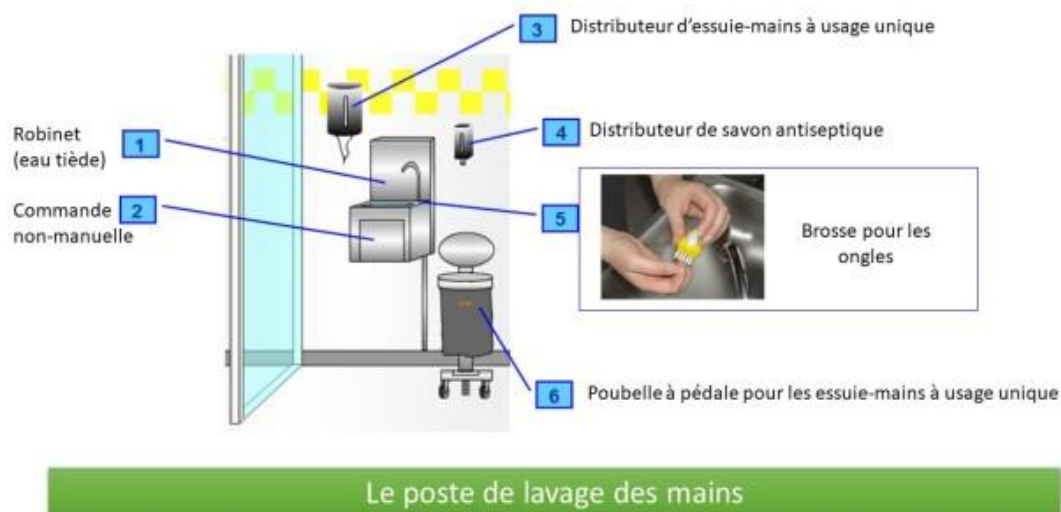
Figure 2:Le poste de lavage des mains (21)
