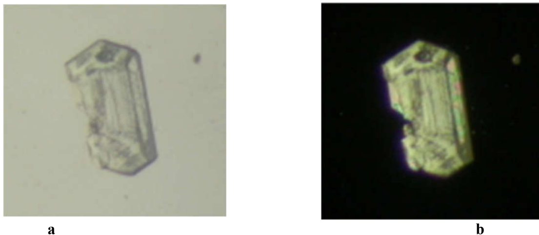
Figure. I. 8 : (a)- Transmission de la lumière naturelle par un monocristal. (b)- Transmission de la lumière polarisée par le même monocristal placé entre deux polariseurs croisés.
