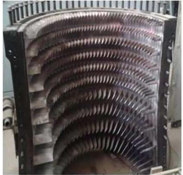
stator du compresseur axial
