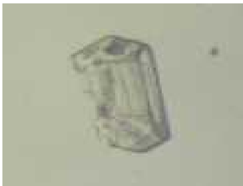
Figure 9 Transmission de la lumière naturelle par un monocristal
