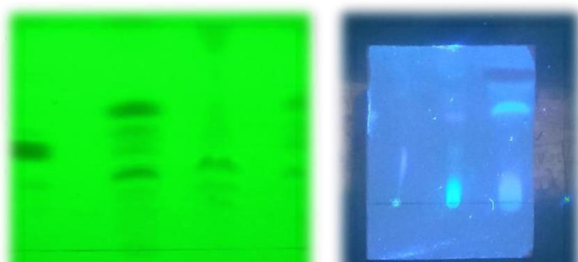
Figure 15: Chromatogramme des différents HEs sur gel de silice, visualisé à 254 et à 365 nm sous UV, utilisant le système éluant cyclohexane/acétate d'éthyle (90:10)
