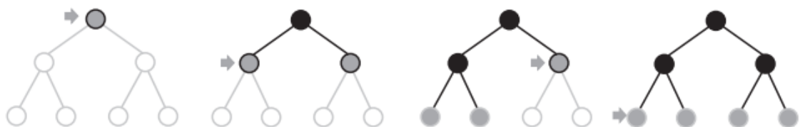
Figure III.4. L'algorithme Breadth-First Search explore d'abord les nœuds les plus proches. Le
