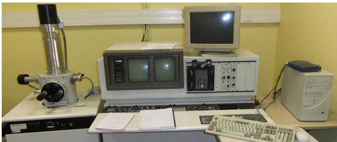
Figure II-6 : MEB de marque HITACHI S-520 au MSMP Arts et Métiers Paris Tech Lille. [15]
