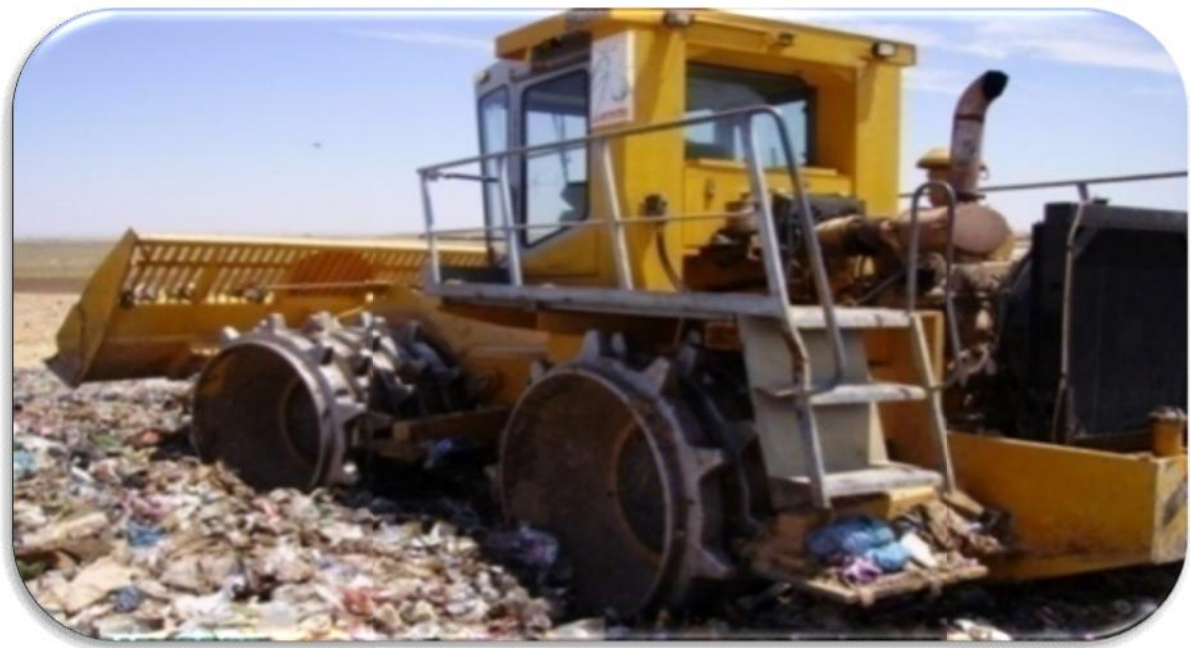
Figure :13- Compactage des déchets
