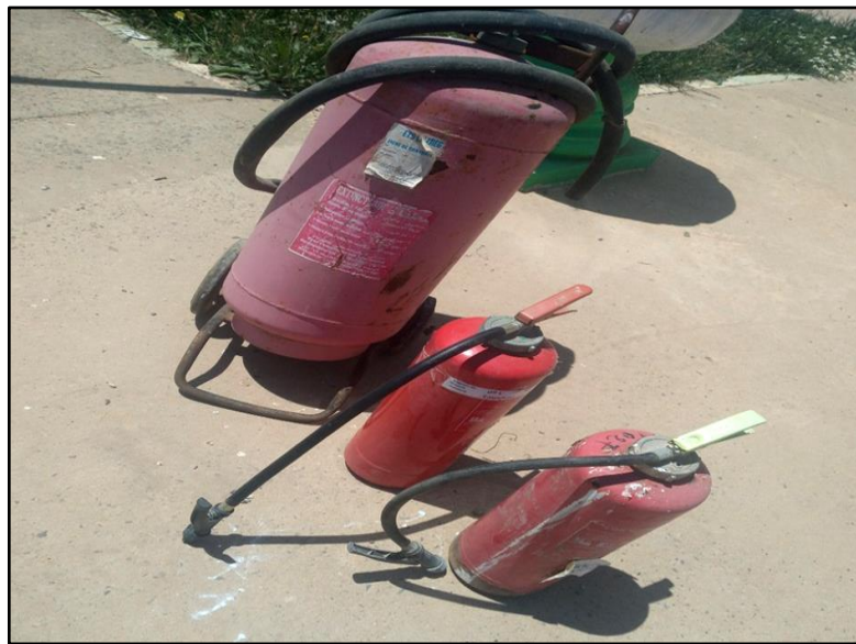
Figure 48 : Extincteurs à différents volumes, (CET, 2022).
