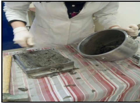
Figure .III.11: La seconde couche de mortier.
