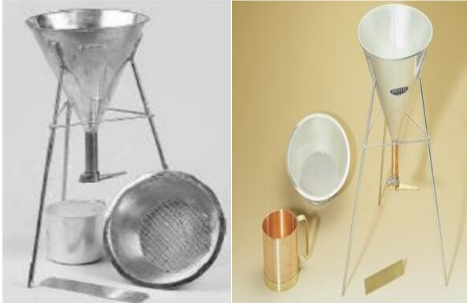
Figure. II.7 : Récipient 1\text{dm}^3 + Entonnoir.
