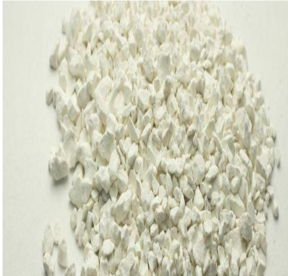
Figure. 1.9 : filler avant broyage.
