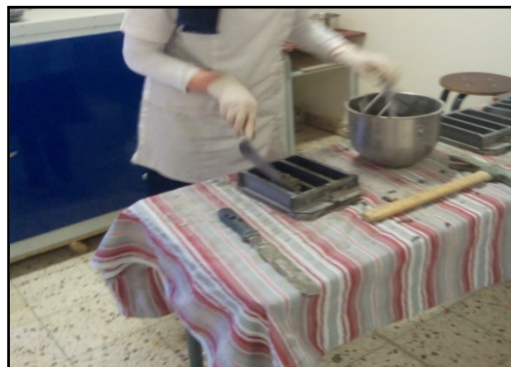
Figure .III.9: La première des deux couches de mortier.
