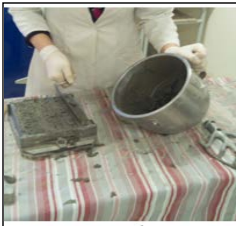
Figure .III.12 : La seconde couche de mortier.
