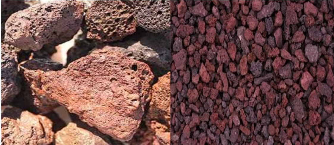
Figure. 1.7 : pouzzolane naturelle avant broyage [3].
