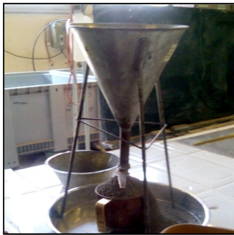
Figure. II.11 : schéma représente la masse apparente de sable.
