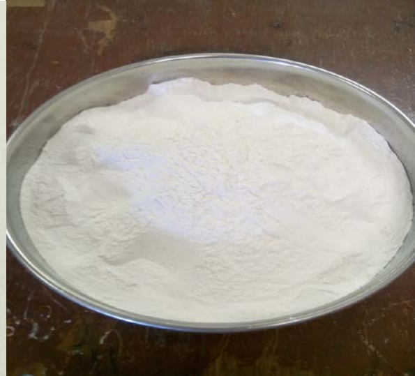
Figure. 1.10 : filler après broyage.
