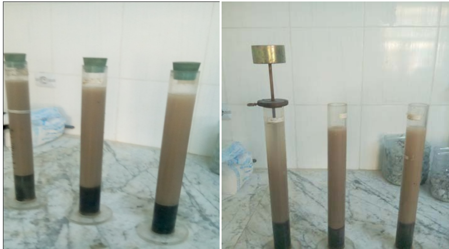
Figure II.3 : équivalente de sable visuel et équivalent de sable au piston.
