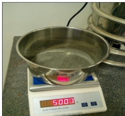
Figure .III.3 : la quantité de ciment.
