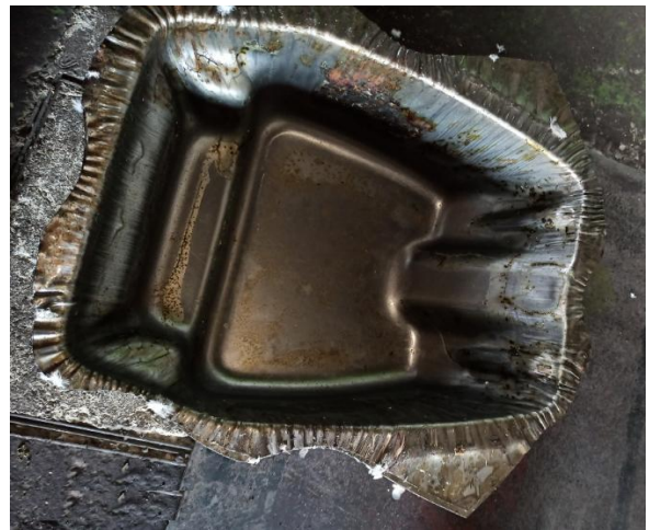
Figure 3.1. Défauts de fissuration et de pliage sous forme des cornes sur l'emboutis.
