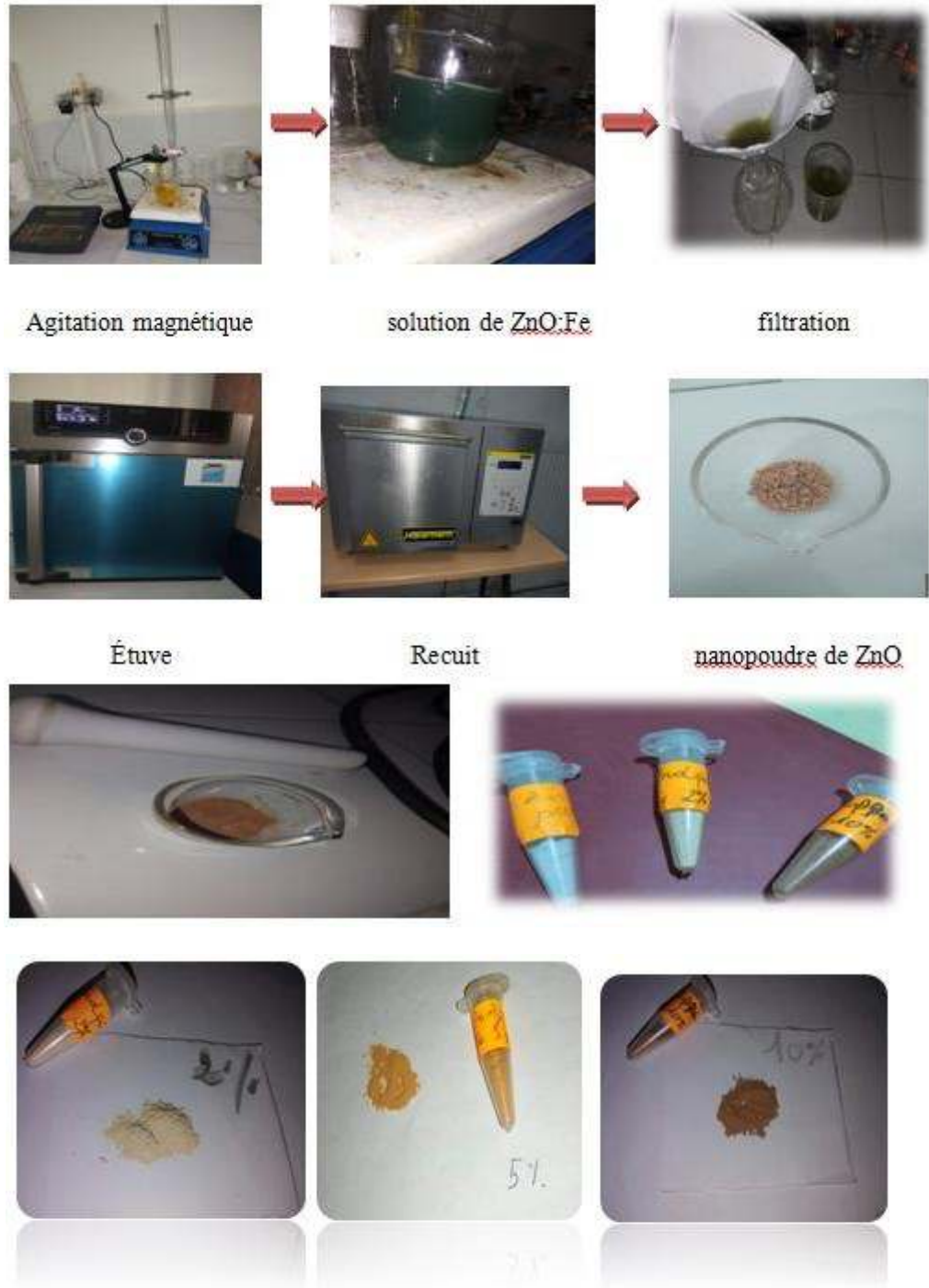
Figure II.4 : les étapes utilisé pour la préparation des poudres de ZnO dopé Fe.
