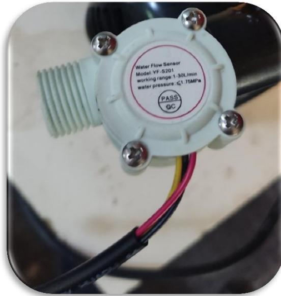
Figure IV.7 : capteur de débit d'eau
