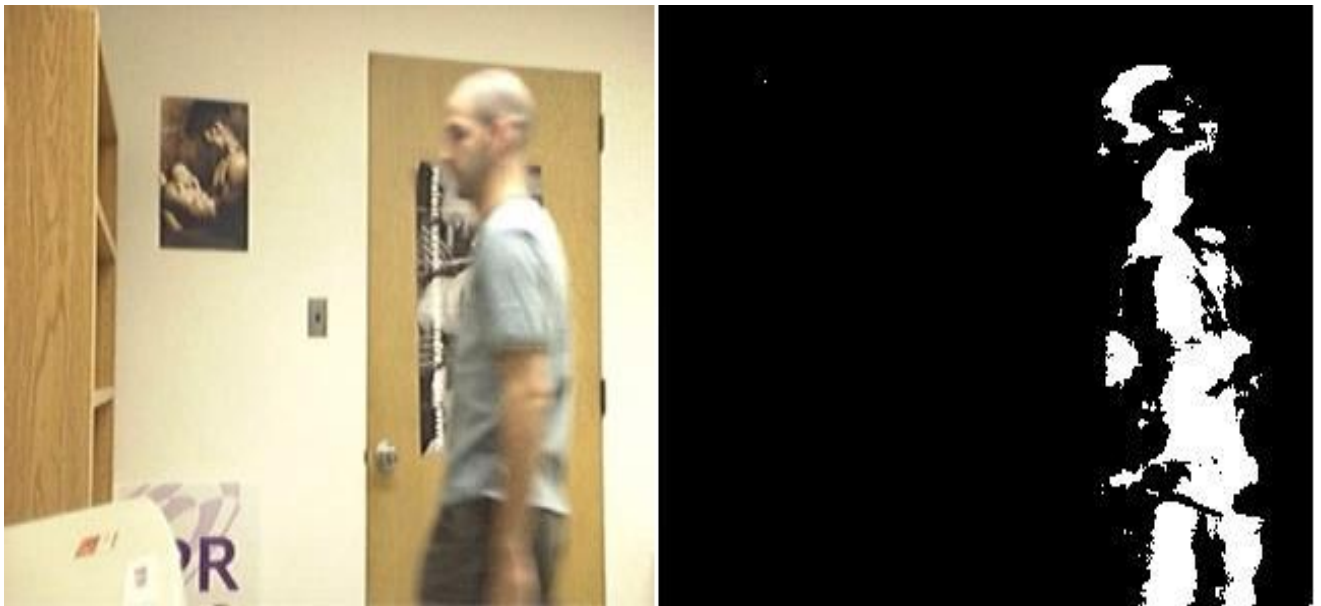
Figure II.1 Exemple de détection du mouvement avec la méthode de la soustraction d'images consécutives
