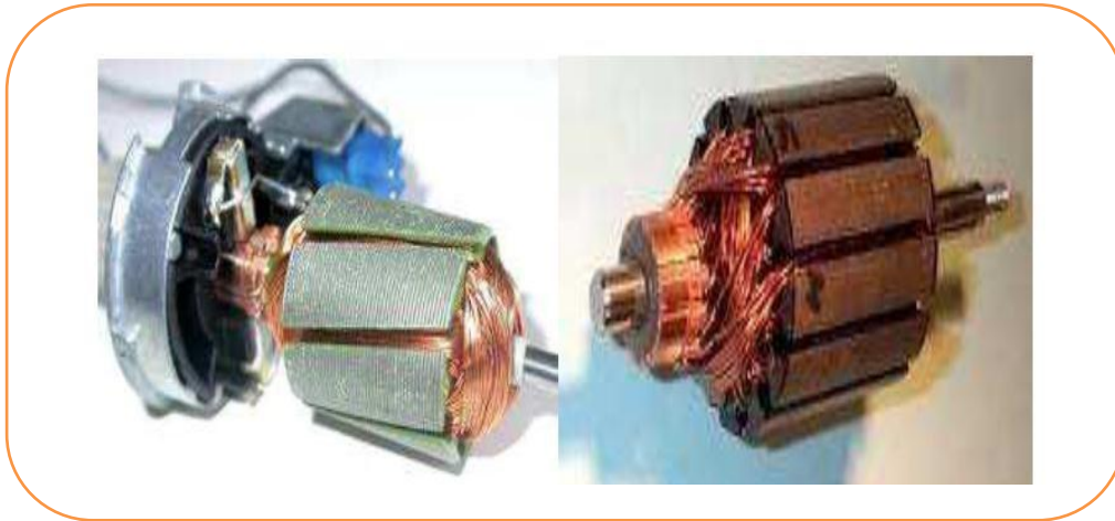
Fig.I.2: Construction d'un rotor bobiné.
