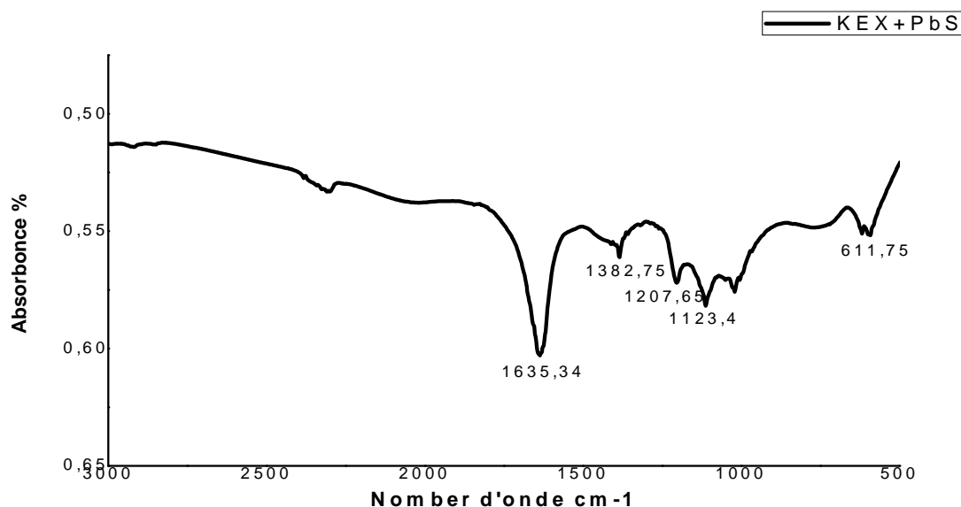
Figure II.7 spectre FTIR de la galène non activée traitée par KEX 10^{-3}\text{M} a pH 9,5.
