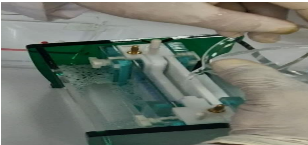
Figure 36 : Le bloc support contenant le tampon d'électrode
