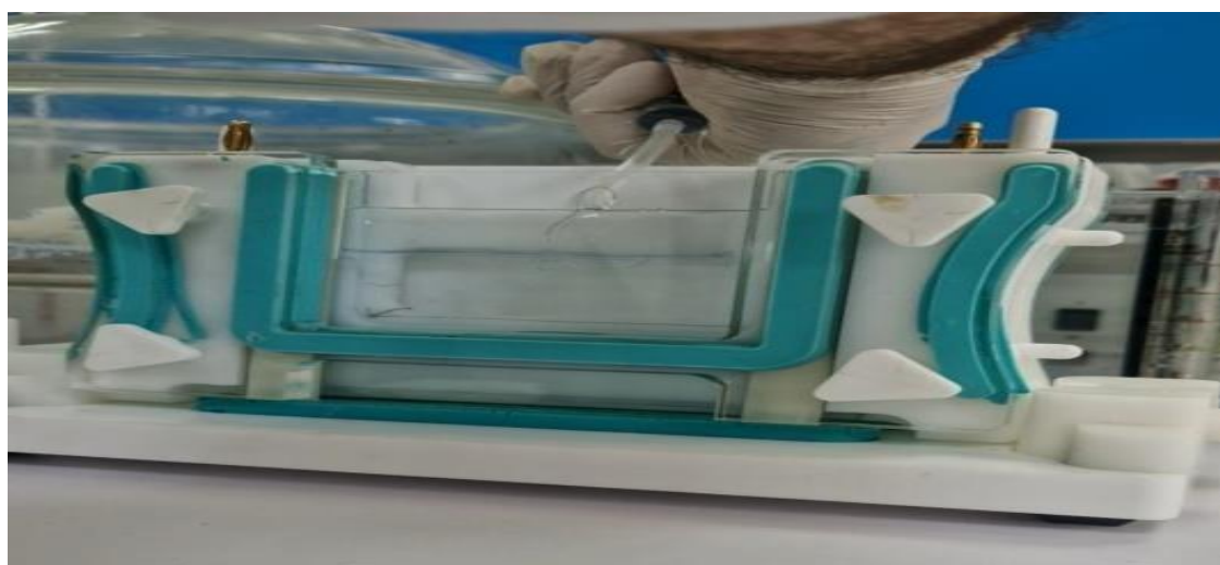
Figure 34 : Coulage des gels entre les plaques
