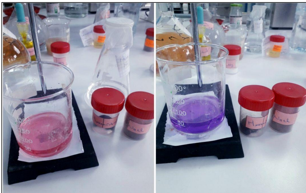
Figure 24: résultat après l'ajout du murexide et le résultat après le titrage avec EDTA.
