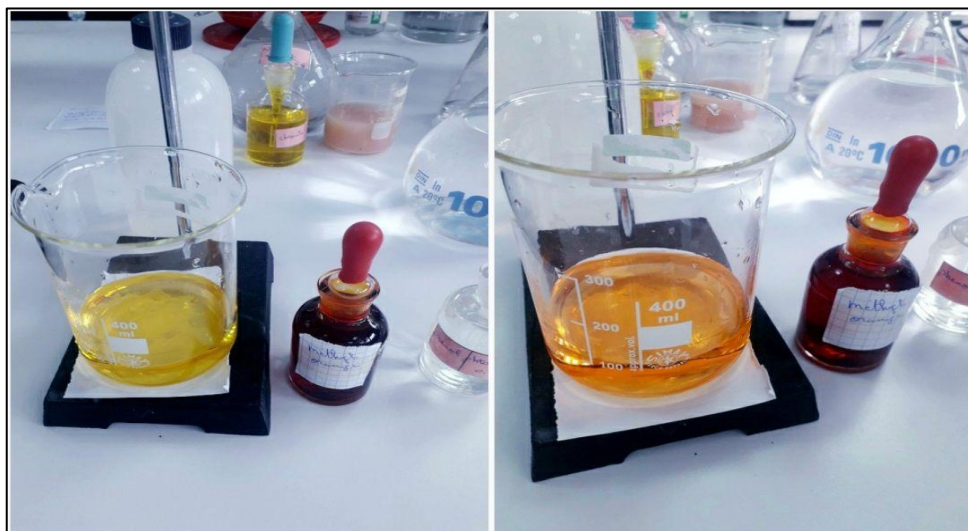
Figure 23 : le résultat après l'ajout du méthyl Orange et le résultat du titrage avec HCl.
