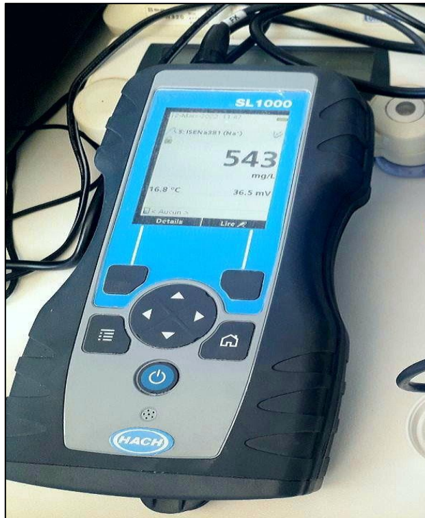
Figure 32: Un multi-paramètre qui permet de mesurer la teneur en sodium.
