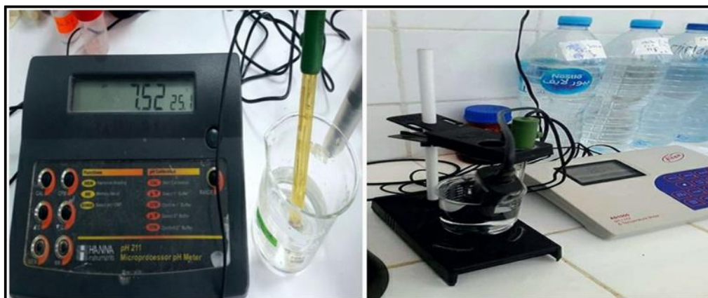
Figure 18: Différents modèles représentent le multi paramètres qui permet de mesurer la température et le pH.
