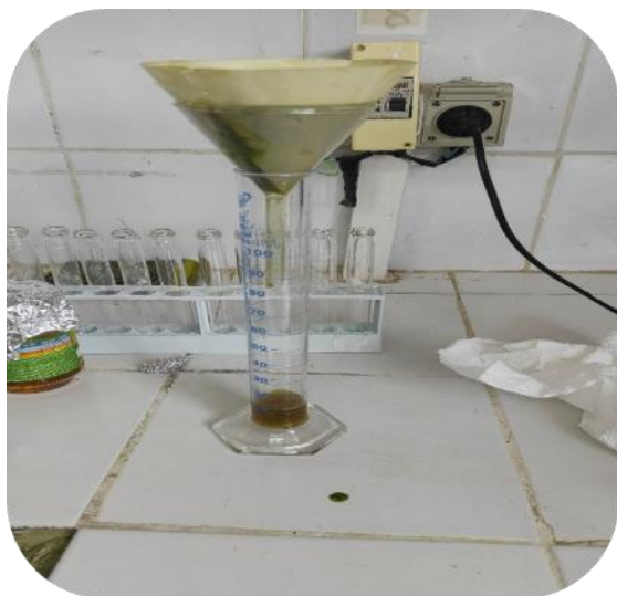
Figure : préparation de l'extrait éthanolique (Macération 24h ; Filtration ; Evaporation au Rotavapeur (45°C) ; extrait éthanolique).
