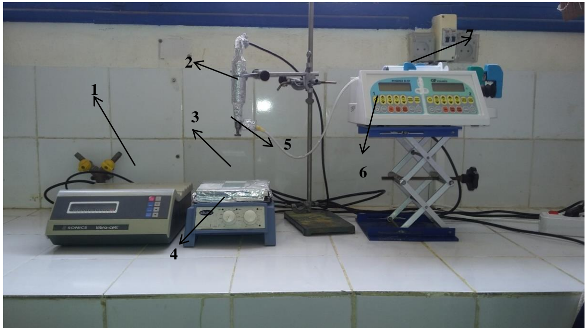
Figure II. 7. Dispositif de dépôt de couches minces par spray pyrolyse ultrasonique.
