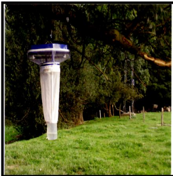
Annexe 2 : Pièges lumineux utilisés pour la capture des Culicoides (à droite : piège original, à gauche : piège personnel confectionné)
