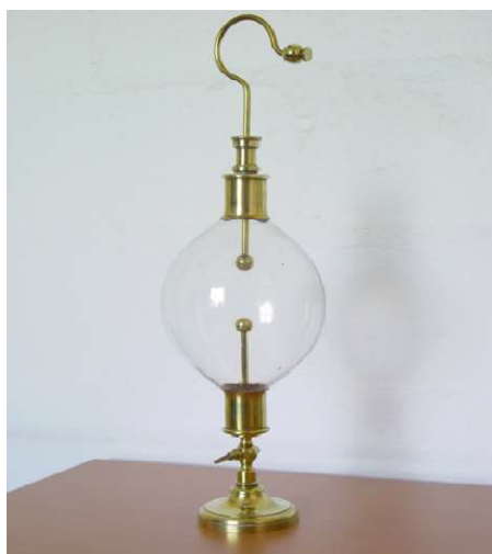
Figure II.4 : Appareil de Faraday. Appareil pour étudier les décharges électriques dans les gaz. Image : collection du département Des sciences de la matière ENS Lyon
