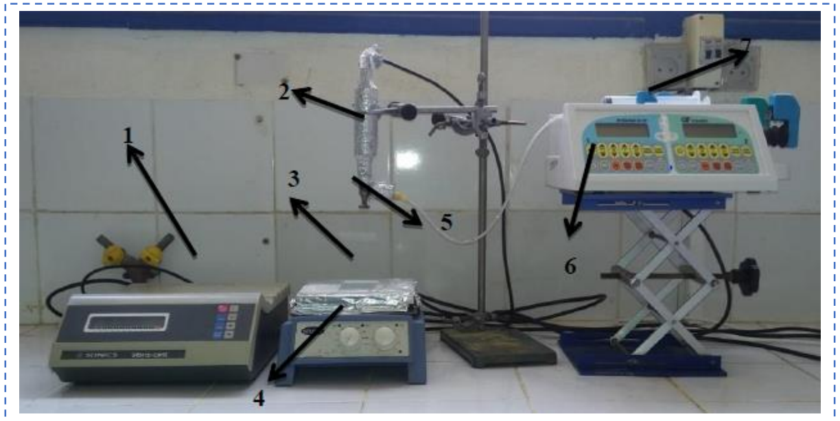
Figure II.7. Dispositif de dépôt des couches minces par spray pyrolyse ultrasonique
