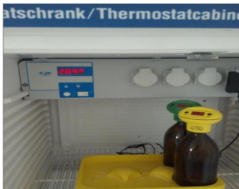
Photo 05 : La mesure de DBO 5 dans une armoire thermorégulatrice.
