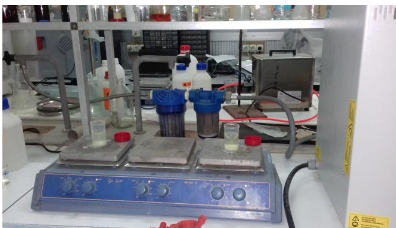
Figure II .1 : Méthode de préparation de la solution par agitation magnétique.
