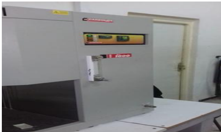
Figure II.4 : Four utilisé pour traitement thermique.
