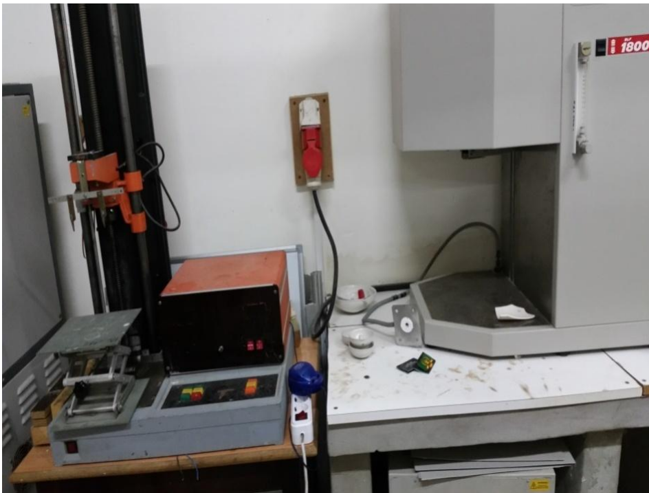
Figure II.5 : Dispositif de dépôt des couches minces par dip-coating.
