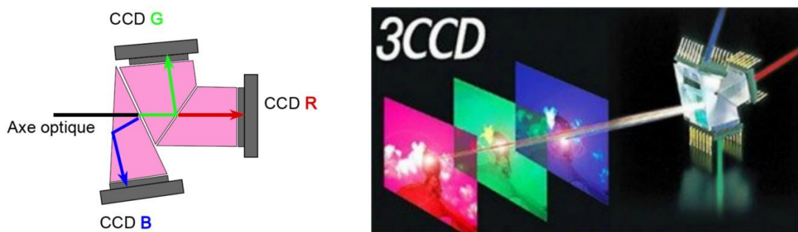
Figure 1.12 . Schéma de principe d'un Capture Tri-CCD (charged coupled device)
