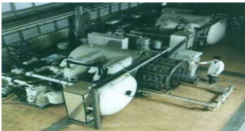
Figure I.5. Groupe de pompage industriel en phase chargement [1].
