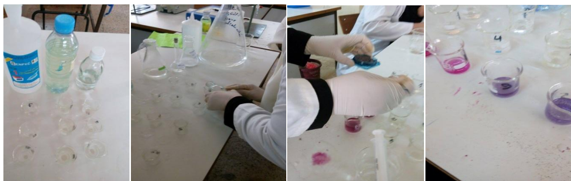
Photo 8 : Titration à l'EDTA pour détecter le calcium de deux échantillons.
