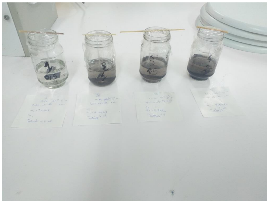
Figure (15) : Echantillon d'acier dans une solution acide H_3PO_4 avec inhibiteur.
