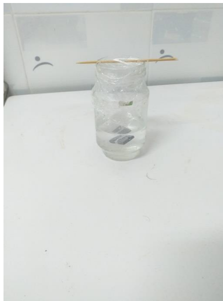
Figure (13) : Echantillon d'acier dans une solution acide H_3PO_4 sans inhibiteur.
