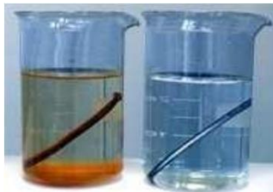
(a) sans inhibiteur de corrosion.
