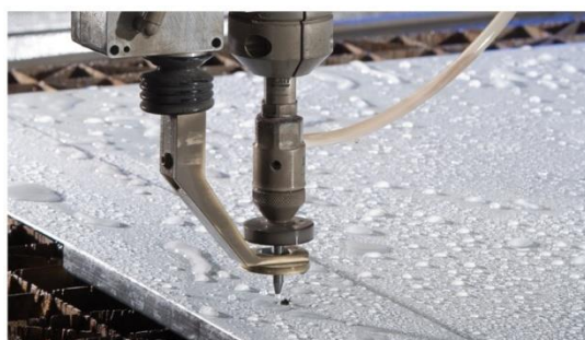
Fig. I.25 : Découpage par jet d'eau.
