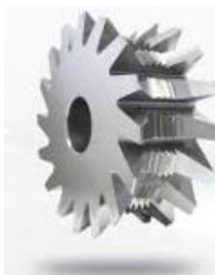
Fig. I.14 : Profil d'une fraise de forme à denture détalonnée.
