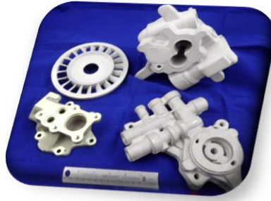
Fig. II.4 : Exemple de fonderie en sable (pièce en aluminium).
