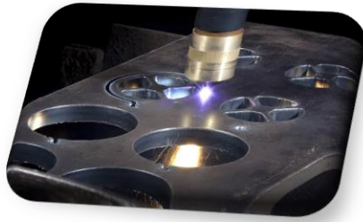
Fig. I.26 : Découpage plasma réalisé par un robot industriel.
