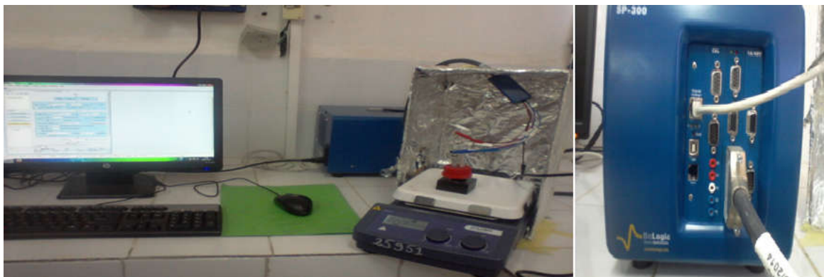
Figure III.1 : Appareillages de mesures électrochimiques.
